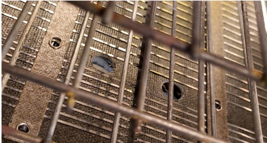
Abbildung 4-3: Pressglimmerplatte mit Löchern für optischen Sensoren
