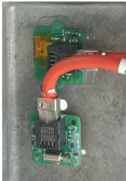
Abbildung 0-4: Finaler Prototyp, Montage Encoder und Display Modul
