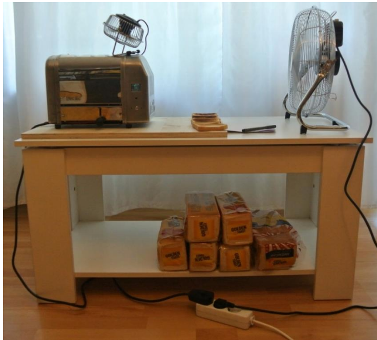
Abbildung 5-2: Messsystem wird auf Anfangstemperatur gekühlt
